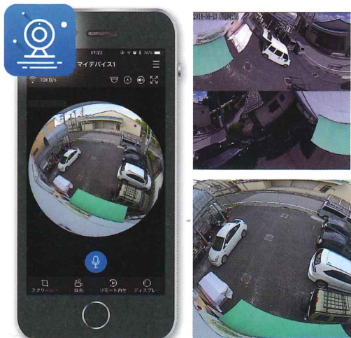
▲携帯 (iPhone・Android) / PC (Windows) から360°ポイント操作でリアルタイム映像・録画映像を確認できます。
